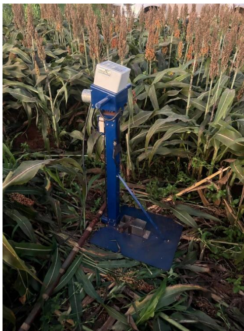
Figura 3. Penetrômetro para a análise de resistência à penetração, Cassilândia, MS, 2025.
